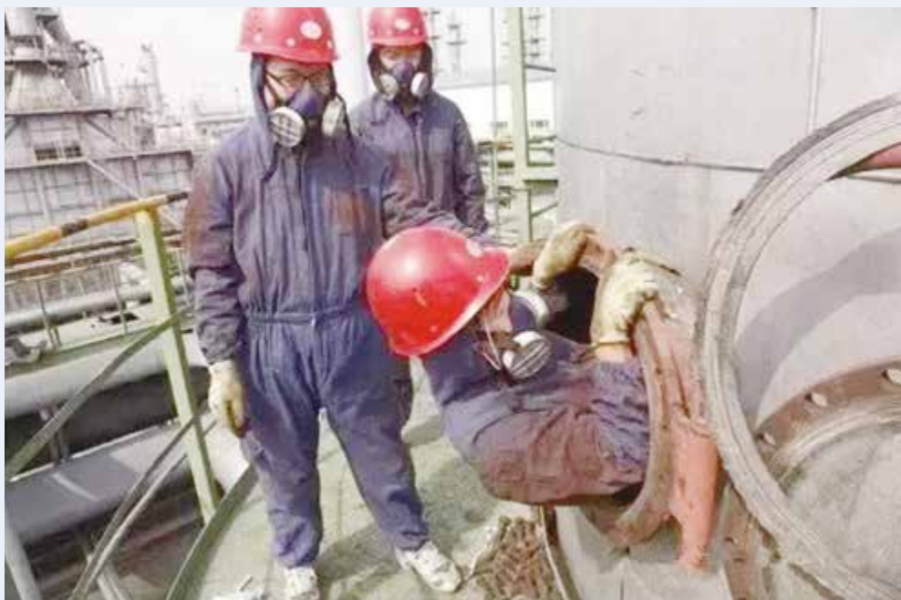
圖4. 用鐵絲清除堵塞物時，內容物會急速噴出
