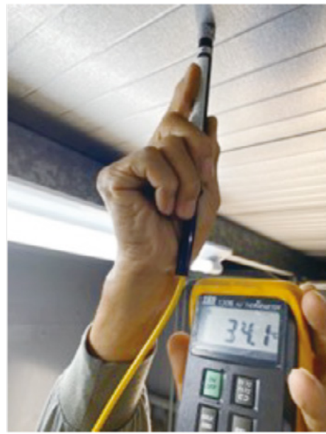
塗布後，室內屋頂量測溫度34°C
