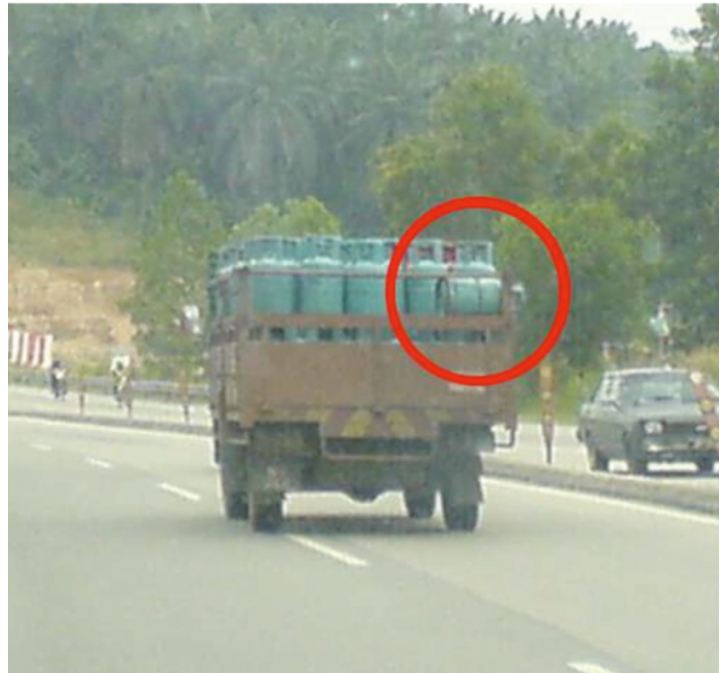
圖9.貨車違規裝載瓦斯鋼瓶網綁不牢搖搖欲墜
