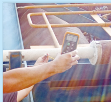
照片說明：尚未噴塗保溫塗料的管線量測到溫度約為102°C(左圖)，使用保溫塗料之後測得溫度降至78度°C(右圖)。
