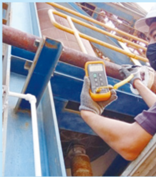
照片說明：尚未噴塗保溫塗料的管線量測到溫度約為102°C(左圖)，使用保溫塗料之後測得溫度降至78度°C(右圖)。
