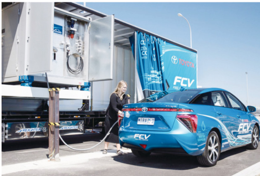
圖說1：TOYOTA（豐田）為「Mirai」車款所打造的「貨櫃式加氫站」，是一部Hino 700拖車頭改裝而成的加氫站。（圖片取自網路）
