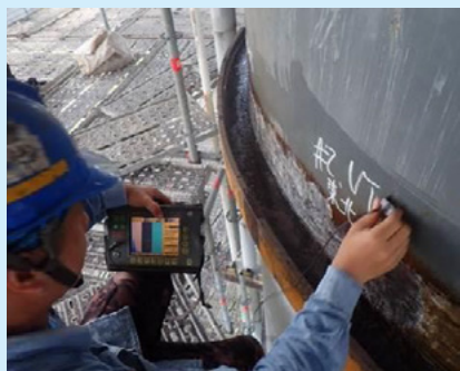
14. 各熔填部實施全面超音波檢測(UT)，確認無銲道內部缺陷。
