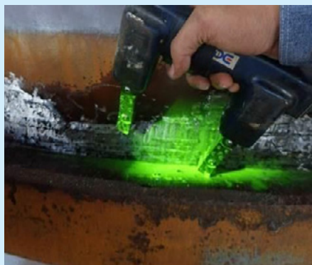
16. 耐壓試驗後，各處熔填部表面實施磁粒檢測(MT)，確認無裂縫。
