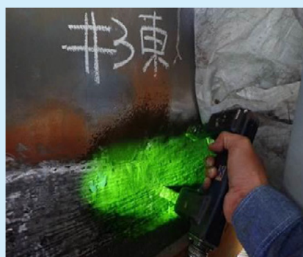
16. 耐壓試驗後，各處熔填部表面實施磁粒檢測(MT)，確認無裂縫。
