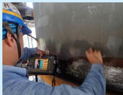
14. 各熔填部實施全面超音波檢測(UT)，確認無銲道內部缺陷。
