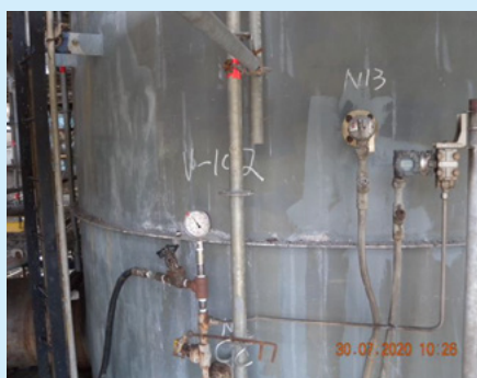
15. 槽體實施耐壓試驗，確認修繕部分緊密之整體無洩漏，驗證強度。
