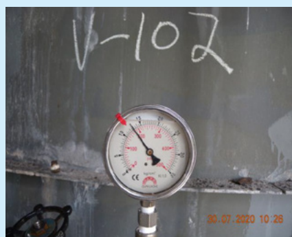
15. 槽體實施耐壓試驗，確認修繕部分緊密之整體無洩漏，驗證強度。
