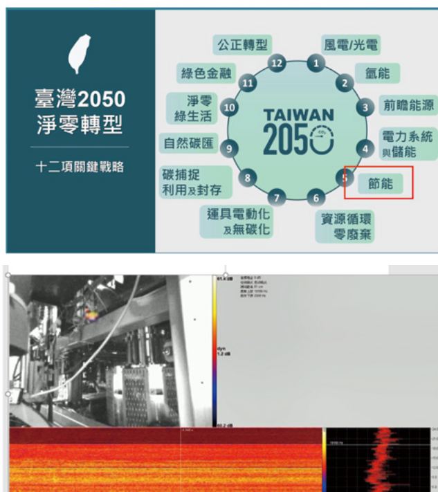
上圖為常見無塵室機房內的管線氣體洩漏
