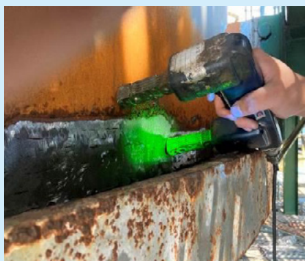
17. 耐壓試驗後，各處熔填部表面實施磁粒檢測(MT)，確認無裂縫。
