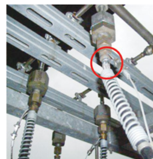
圖五、高壓灌裝軟管可配有彎曲限制的彈簧。左邊彈簧安裝正確，右邊彈簧未確實安裝，造成上方有脫落現象。
