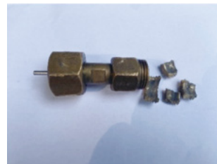
圖三、黃銅填充連接器牙條斷裂
