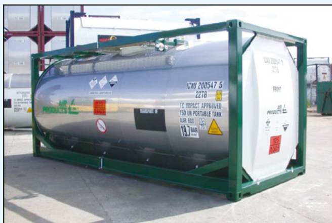
圖3 移動式氣體容器（Portable Tank）
