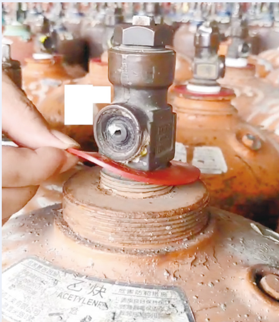
鋼瓶未檢驗直接套入識別環
