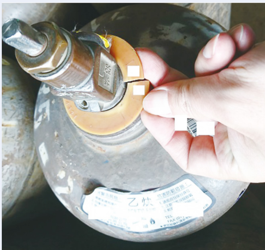
鋼瓶未檢驗直接套入識別環
